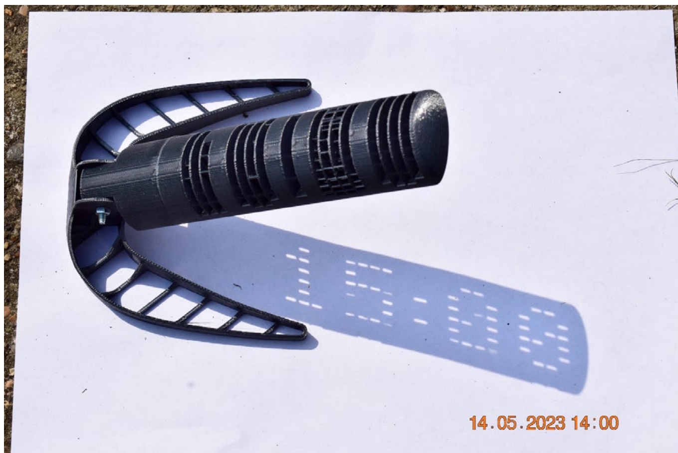
Figura 1. Reloj digital de proyección solar construido con impresora 3D. Foto: Ramón Hartopp Sancho
